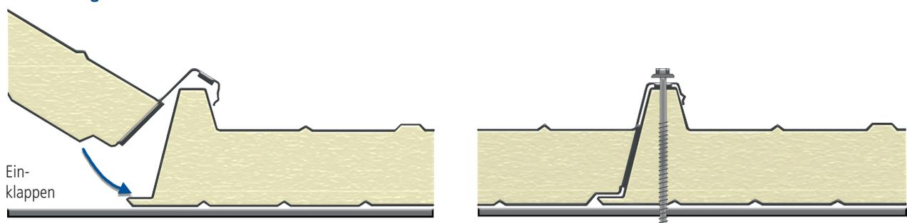
Das erste Element ist exakt auszurichten und sofort zu befestigen. Jedes weitere Element ist auf die Hochsicke des bereits verlegten Elements schräg aufzusetzen (ca. 45°) und auf die Konstruktion abzulassen.
